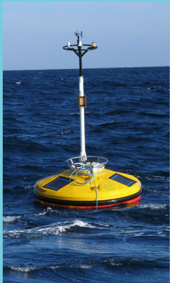
Imatge d'una boia WaveScan de Ports de l'Estat utilitzada per al mesurament de variables oceanogràfiques i de temperatura de l'aire sobre la mar a 3 m sobre l'aigua. FONT: Ports de l'Estat.
