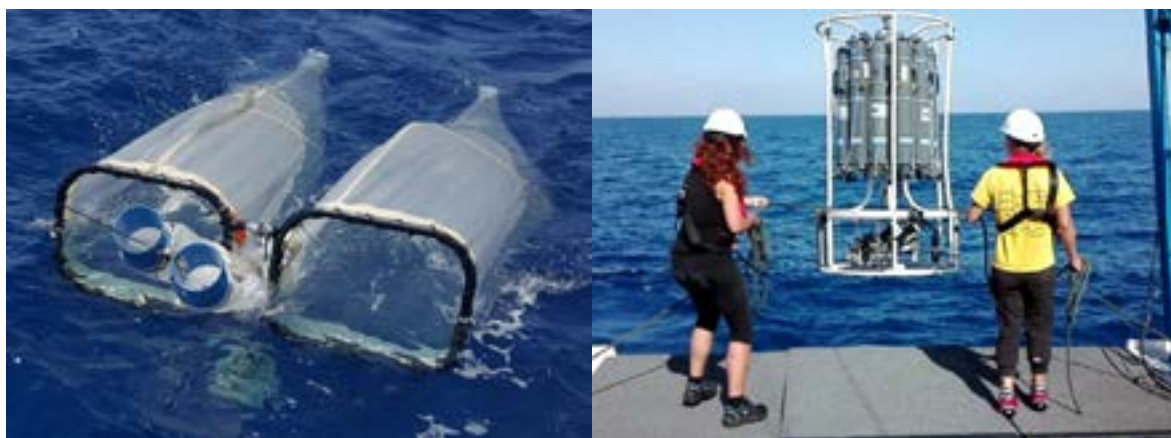
Figura 4. A l'esquerra, pesca de larves amb xarxes bongo; a la dreta, presa de mostres d'aigua i perfils verticals de paràmetres ambientals amb CTD. FONT: COB-IEO i SOCIB
