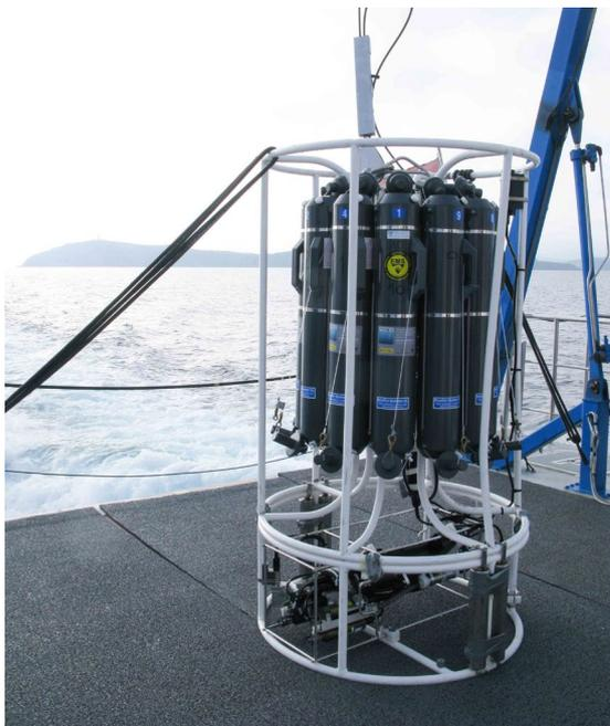
**Figura 1.** Ejemplo de dispositivo CTD utilizado en campañas oceanográficas para medir parámetros de temperatura, salinidad y profundidad, entre otras variables. FUENTE: Miquel Gomila.
