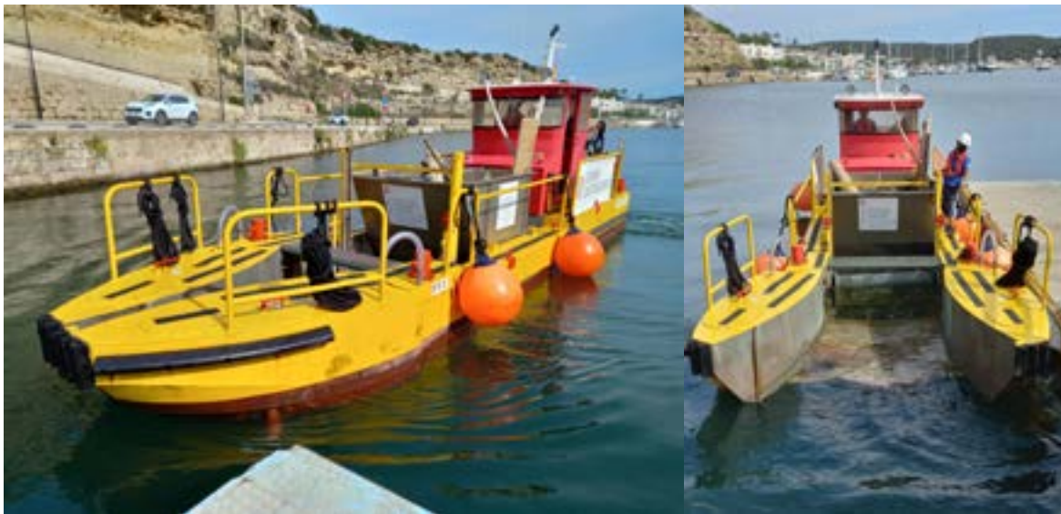
Figura 1. Imágenes de embarcaciones de tipo litoral (Pelicà), las de mayor capacidad de recogida de la flota. FUENTE: CNL (ABAQUA).
