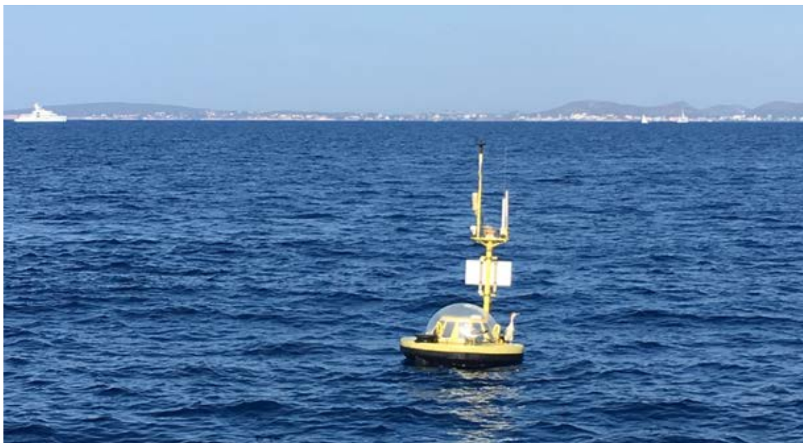
Figura 3. Boya oceanográfica del SOCIB en la bahía de Palma utilizada para medir las variables oceanográficas de superficie (~5 m de profundidad). FUENTE: Natalia Barrientos.
