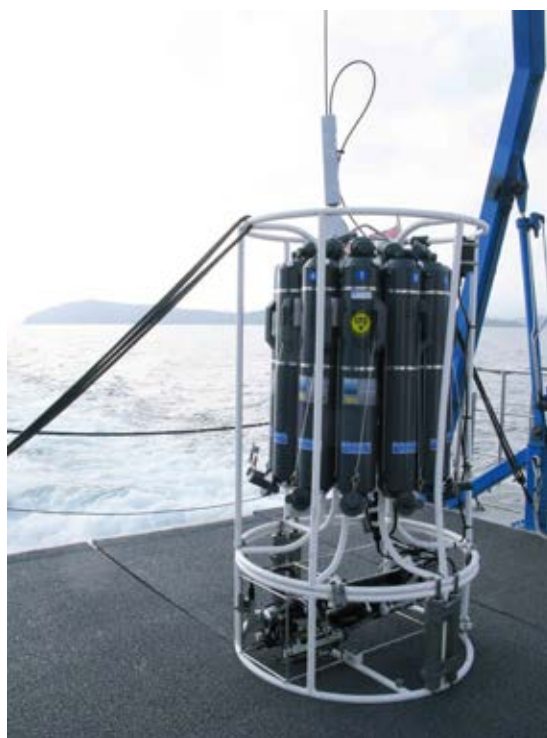
Figura 2. Ejemplo de dispositivo CTD utilizado en campañas oceanográficas para medir parámetros de temperatura, salinidad y profundidad, entre otras variables. FUENTE: Miquel Gomila.
