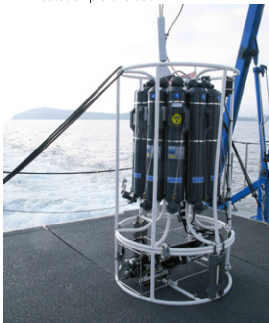
Figura 2. Ejemplo de dispositivo CTD utilizado en campañas oceanográficas para medir parámetros de temperatura, salinidad y profundidad, entre otras variables. FUENTE: Miquel Gomila.
