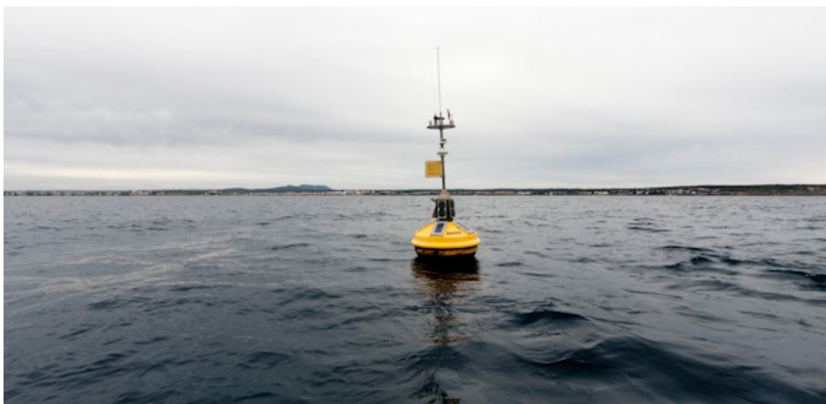
Figura 1. Imagen de la boya de Palma del SOCIB utilizada para medir variables oceanográficas como la salinidad. FUENTE: SOCIB.
