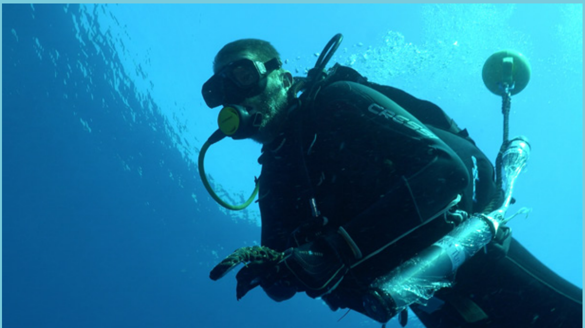
Imagen de la instalación de un hidrófono, aparato utilizado para la medición de sonidos submarinos. FUENTE: Asociación Tursiops.
