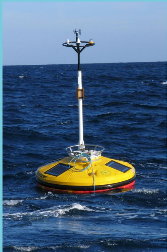
Imagen de una boya WaveScan de Puertos del Estado utilizada para medir variables oceanográficas y de temperatura del aire sobre el mar a 3 m sobre el agua. FUENTE: Puertos del Estado.
